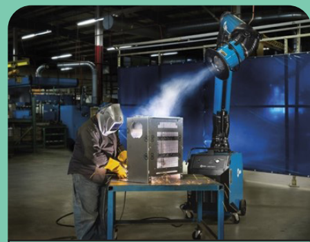
شکل ۱. استفاده از تهویه متحرک در عملیات جوشکاری
